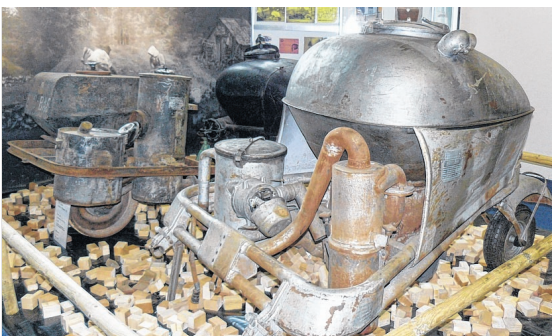
Als Holzkohlevergaser waren Einradanhänger auch eine Zeit lang nützlich. Foto: Michael Woll
