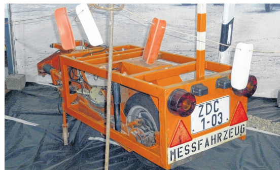
Aus der ehemaligen DDR stammt dieses Messfahrzeug, mit dem Straßenbeläge überprüft wurden. Foto: Heinz Schliehe
